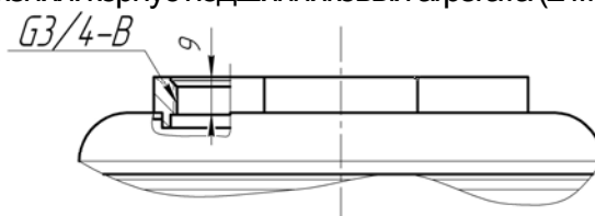
Рисунок Б.24 – Присоединительные размеры под установку датчиков уровня
